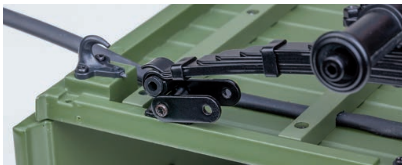
Шаг 6. Аналогичным образом поместите вторую втулку в задний конец рессоры. Закрепите рессору внутри серьги заднего кронштейна при помощи винта 2,0×11 (УМ).
