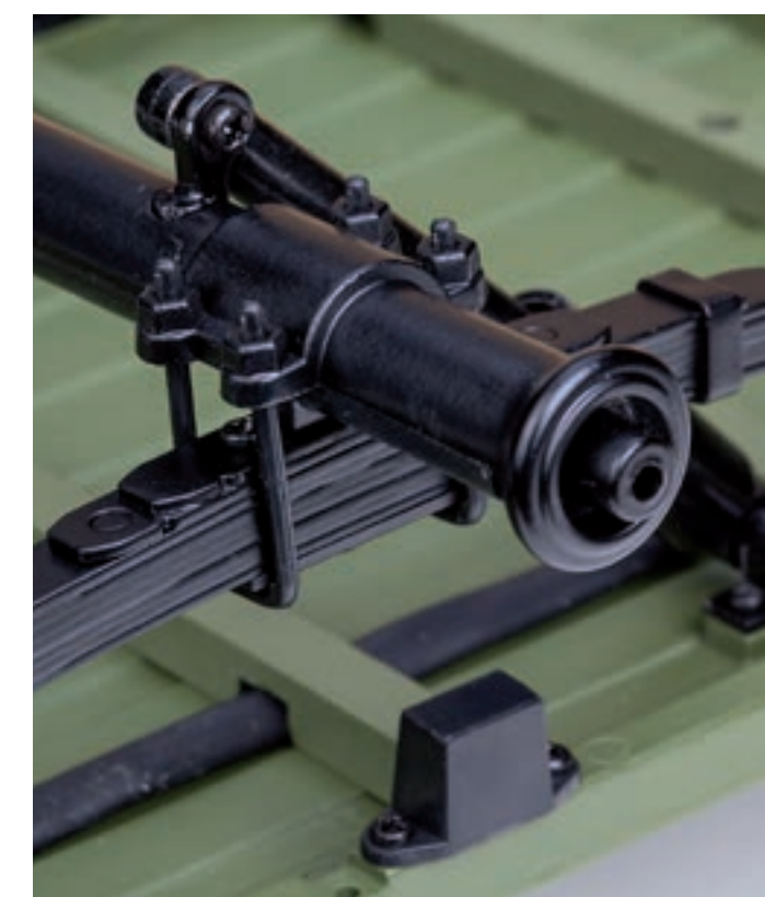
Шаг 7. Установите стремянки на левую рессору оси прицепа. Для этого поместите одну стремянку перед осью, а вторую — позади оси, со стороны рессоры. Закрепите стремянки в отверстиях накладки оси прицепа. Детали должны держаться в отверстиях за счет трения.
